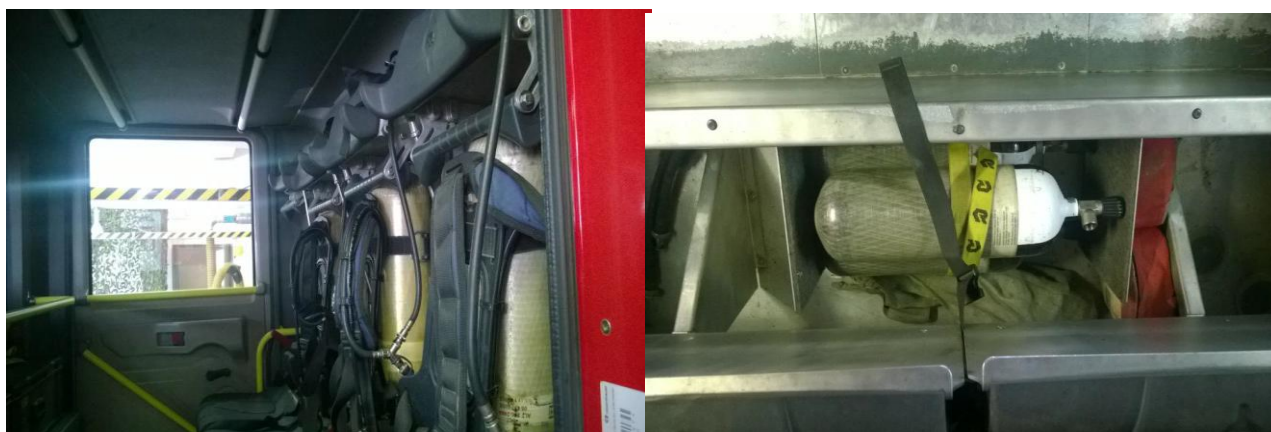
Рис. 2. Расположения СИЗОД и резервных баллонов на АЦ 3,2-40/4 (43253)001МС
