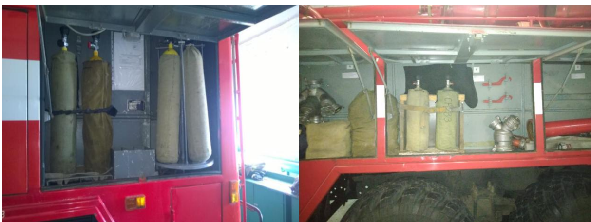
Рис. 1. Опытные варианты размещения резервных баллонов для ДАСВ
